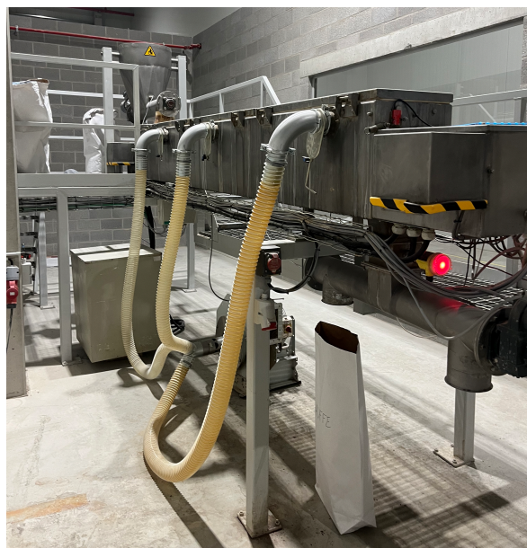
Figure 9 – Convoyeur à vis chauffé électriquement SpiraJoule pilote, Castle Ingredients®
