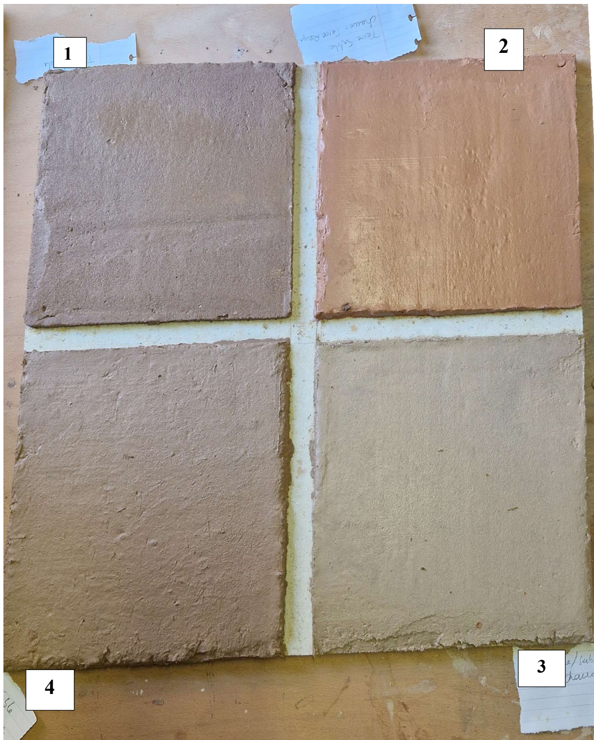
Figure 76. Test d'enduit en terre crue. Crédit : Daniel Djike (2025)
