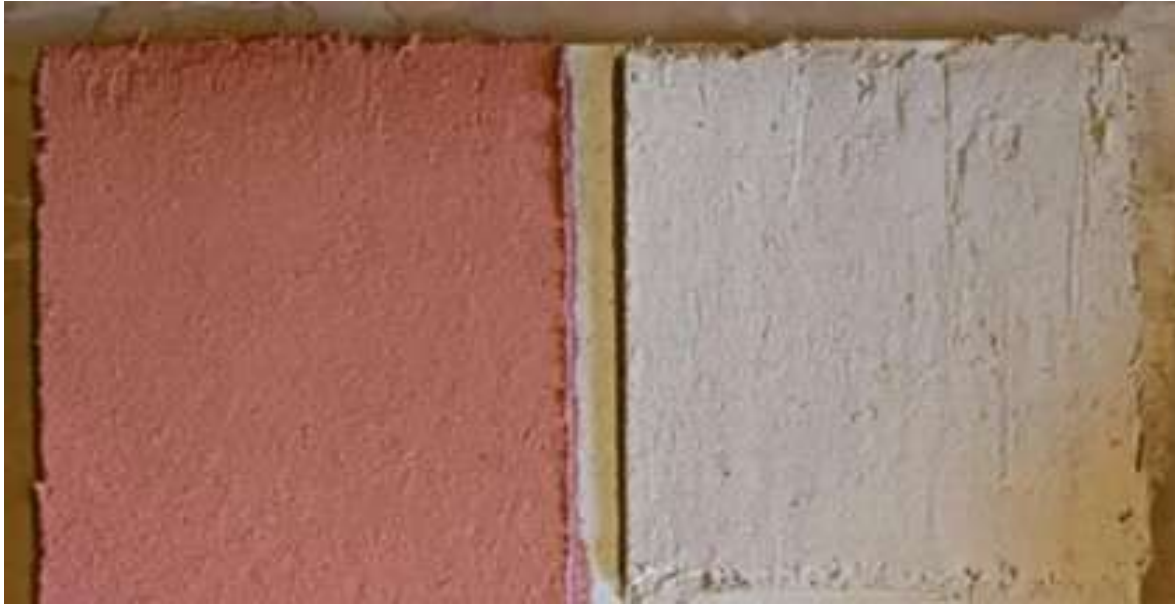
Figure 77. Test d'enduit de Terre + chaux + sable + fibre de miscanthus avec ajout de colorant. Crédit : Daniel Djike (2025)
