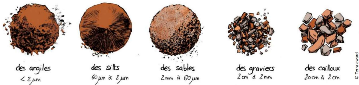
Figure 9. Les composants solides de la terre crue. Crédit : Fontaine et al., 2009, p. 102
