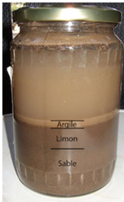
Figure 75. Test granulométrique à la bouteille. Crédit : Daniel Djike (2025)
