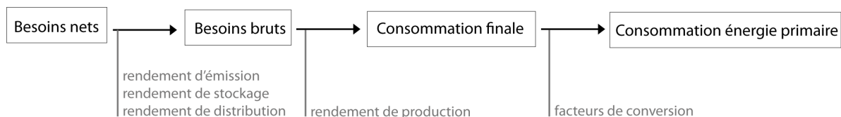
fig. 16: Passage des besoins nets à la consommation en énergie primaire pour le chauffage (source: Annexe 1 du décret wallon de la performance énergétique des bâtiments)
