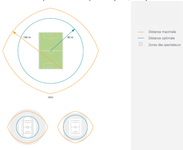
Figure 26: distance optimale et distance réelle entre les spectateurs et le terrain dans le cas d'un stade avec et sans piste d'athlétisme (FIFA, 2011)
