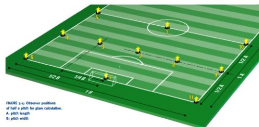
Figure 34: Positions à prendre en compte lors de l'évaluation du GR (Interview de Monsieur van Goethem)
