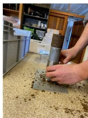
Figure 6. Démoulage des kopecky pour le Quantislake test
