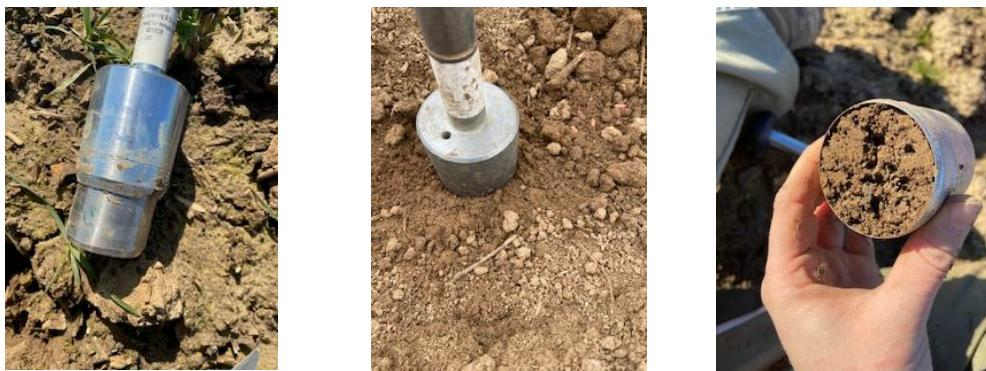
Figure 5. Prélèvements pour le Quantislake test
