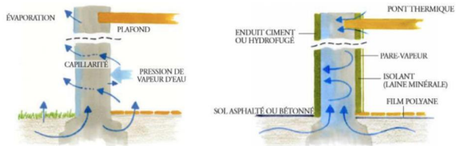
Figure 9 - Fonctionnement hygrométrique d'un mur traditionnel (a) non isolé et (b) isolé de façon moderne (MPF, 2011)
