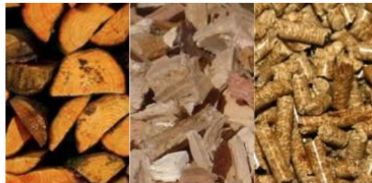
Figure 46 - Combustibles : bûches, plaquettes, pellets (Architecture et Climat, 2013)
