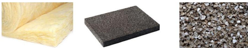
Figure 41 - (a) Laine de roche – (b) Verre cellulaire – (c) Vermiculite (Construire Durable, 2014)
