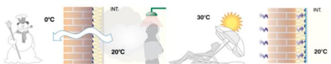
Figure 24 - Situation sans pare-vapeur en hiver et en été (Evrard, et al., 2011)
