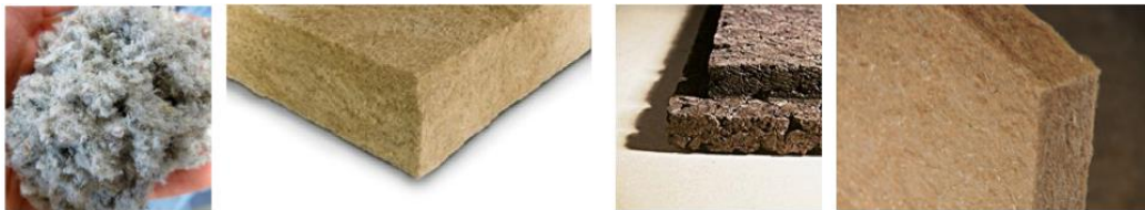
Figure 39 - (a) Cellulose – (b) Fibre de bois – (c) Liège – (d) Chanvre (Ecobati)
