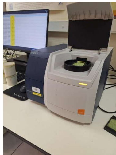
Figure 17. Analyseur proche infrarouge NIRS DS3 (Photo D. Crauwels).
