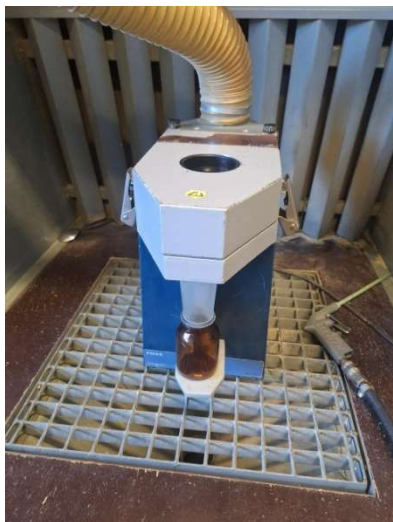
Figure 15. Broyeur Cyclotec (Photo D. Crauwels).
