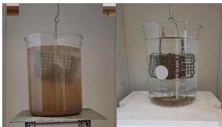
Figure 21 : Échantillons au terme du QuantiSlakeTest – système de culture 1 (gauche) : échantillon fortement dégradé, système de culture 3 (droite) : échantillon moins dégradé.
