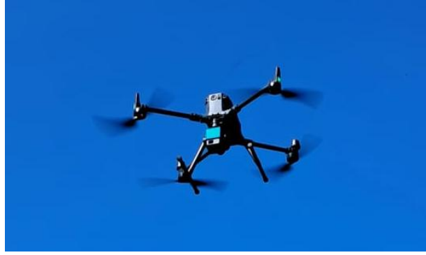
Figure 3 Drone Matrice 350 (DJI) en vol muni d'un capteur LiDAR.
