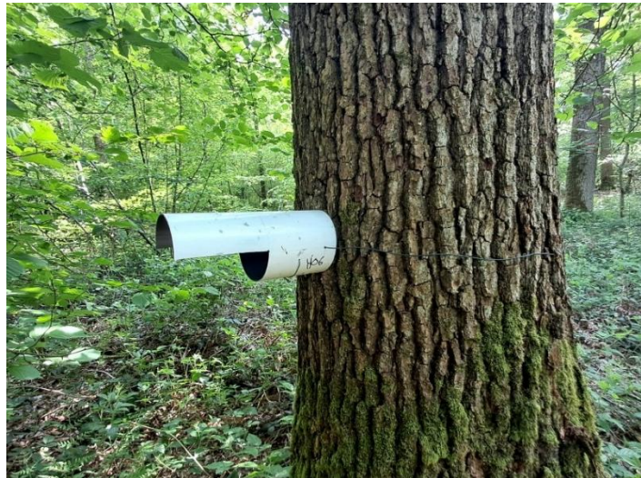
Figure 5 Capteur thermique protégé par un tube PVC blanc accroché à un arbre.
