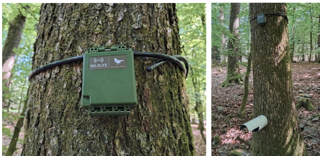
Figure 6 Capteurs acoustiques installés sur le terrain. À gauche : vue rapprochée d'un Song Meter Micro 2 accroché à un arbre à l'aide d'un cadenas. À droite : capteur acoustique associé à un capteur thermique.
