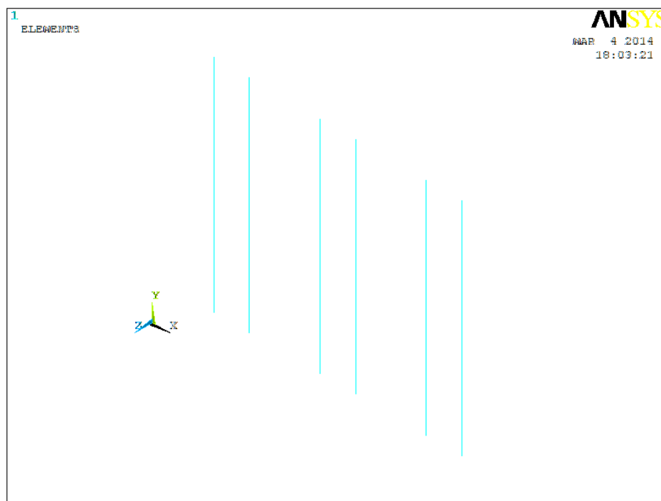
FIGURE 5.21 – Maillage en éléments poutre des raidisseurs
