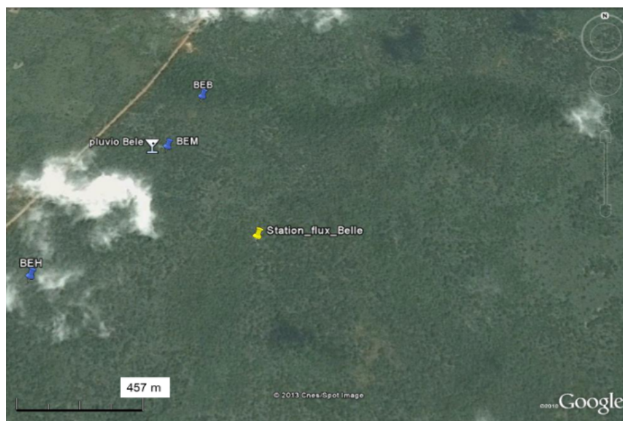
FIGURE 4 – Localisation de la tour à flux, du pluviomètre et des capteurs de teneur en eau du sol dans la forêt claire de Bellefougou
