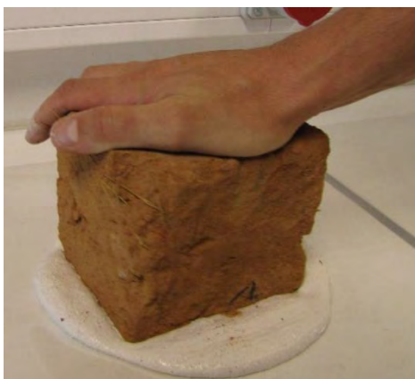
Figure 165 : Application d'une surface d'enduit.
