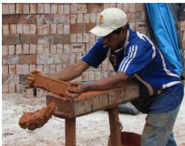
Figure 215 : Etapes de fabrication de briques de terre cuite
