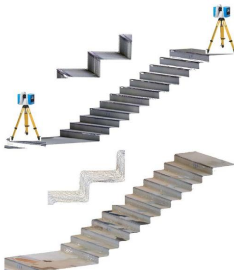
Figure 10 : Relevé d'un escalier en haut avec un TLS et en bas avec un NavVis VLX (Askar et al., 2023).
