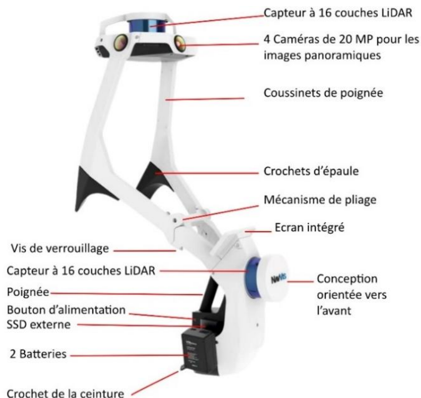
Figure 19 : Description du NavVis VLX deuxième génération dépliée. Annoté par M. Bauvir à partir de la source NavVis Knowledge Base. (2025). Localisation des pièces de votre NavVis VLX. Consulté le 8 avril 2025, à l'adresse https://knowledge.navvis.com/docs/locating-the-parts-of-your-navvis-vlx et d'image Source Géomatching (2025). NavVis VLX2. Consulté le 8 avril 2025, à l'adresse https://geo-matching.com/products/navvis-vlx-2
