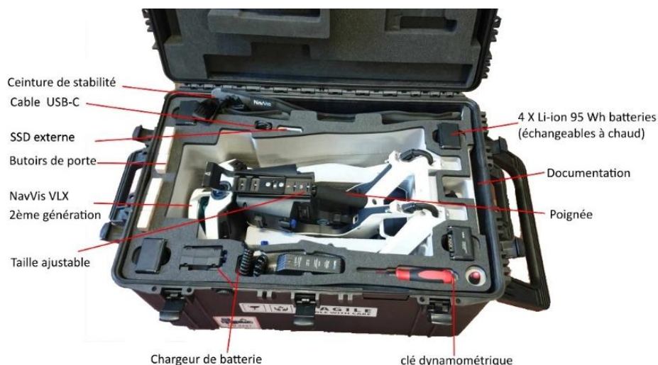
Figure 20 : NavVis VLX 2ème génération dans sa boîte de transport et annoté sur base de la source NavVis knowledge base (2025). Introduction. Consulté le 8 avril 2025, à l'adresse https://knowledge.navvis.com/docs/hardware-setup-instructions . Photographie personnel: © M, Bauvir (Le 22 avril 2024).
