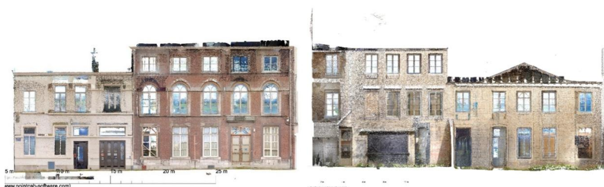
Figure 63: Fichier exporté de la plateforme NavVis IVION du relevé de A. Schreurs et L. Moray de 2024 généré sur PointCab. À gauche, vue des façades côté rue ; à droite, vue des façades côté jardin. ©M. Bauvir
