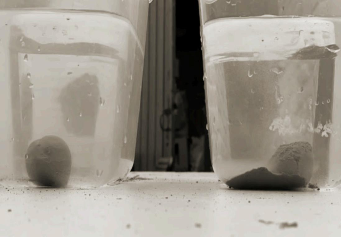
> Figure 79 : Comparaison des réactions entre des échantillons de terre, l'échantillon de gauche ayant été mélangé à du sel. Photographie personnelle, 2024.
