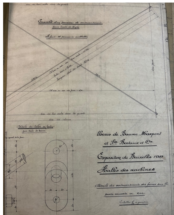
Fig. 24 Plans d'un panneau de contreventement en toiture et d'un talon en fonte, Exposition de Bruxelles 1910
