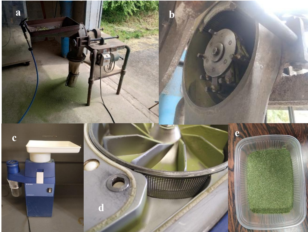
Figure 12 : a et b: broyeur pour le pré-broyage; c et d: broyeur de laboratoire; e: résultat du broyage.
