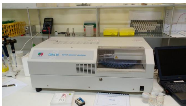
Fig.9 : Le DMA-80 (Direct Mercury Analyzer) permet de déterminer la concentration au mercure de chaque échantillon (Laboratoire d'Océanologie, Université de Liège)
