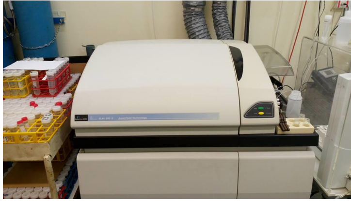
Fig.10 : Spectromètre de masse couplé à un plasma inductif (ICP-MS) (Laboratoire d'Océanologie, Université de Liège)
