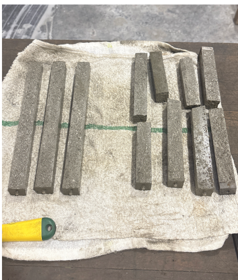
Figure 2.21 – Éprouvettes d'essai cassées
