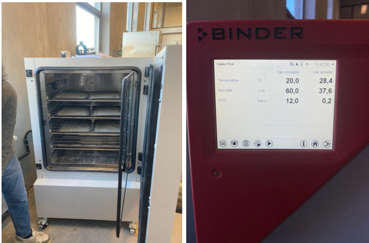
Figure 2.3 – Carbonatation du sable recyclé RS2 (ULiège)
