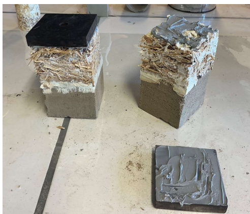
Figure 52 - Application de l'adhésif époxydique bi-composant sur les échantillons
