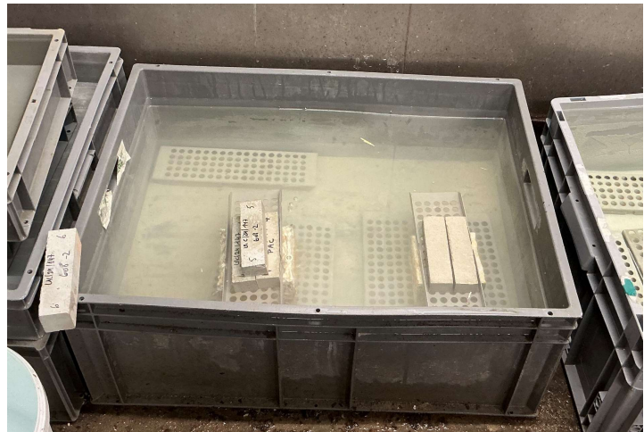
Figure 51 - Installation du dispositif pour l'essai d'absorption d'eau par immersion
