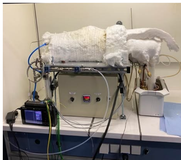
Figure 17 – Image de la boîte à batterie sans laine isolante (gauche) et avec laine isolante (droite)
