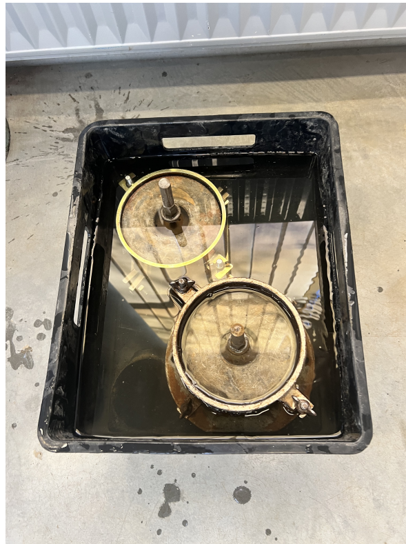
FIGURE 20 – Moule CBR immergé pendant 4 jours Sol/gravier
