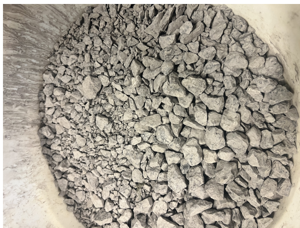
FIGURE 12 – Fondation en granulats calcaire 2/20
