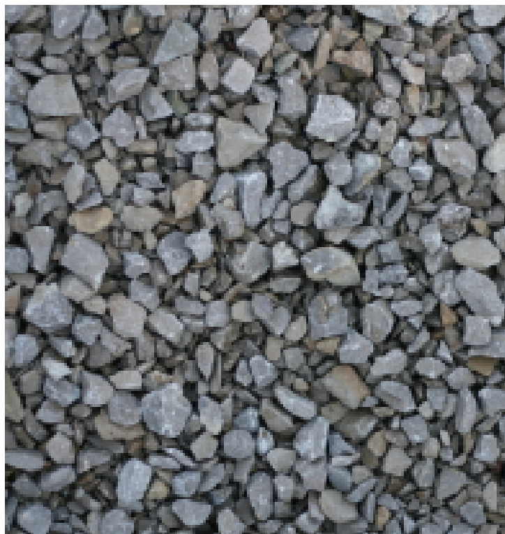
FIGURE 6 – Empierrement à granulométrie continue
