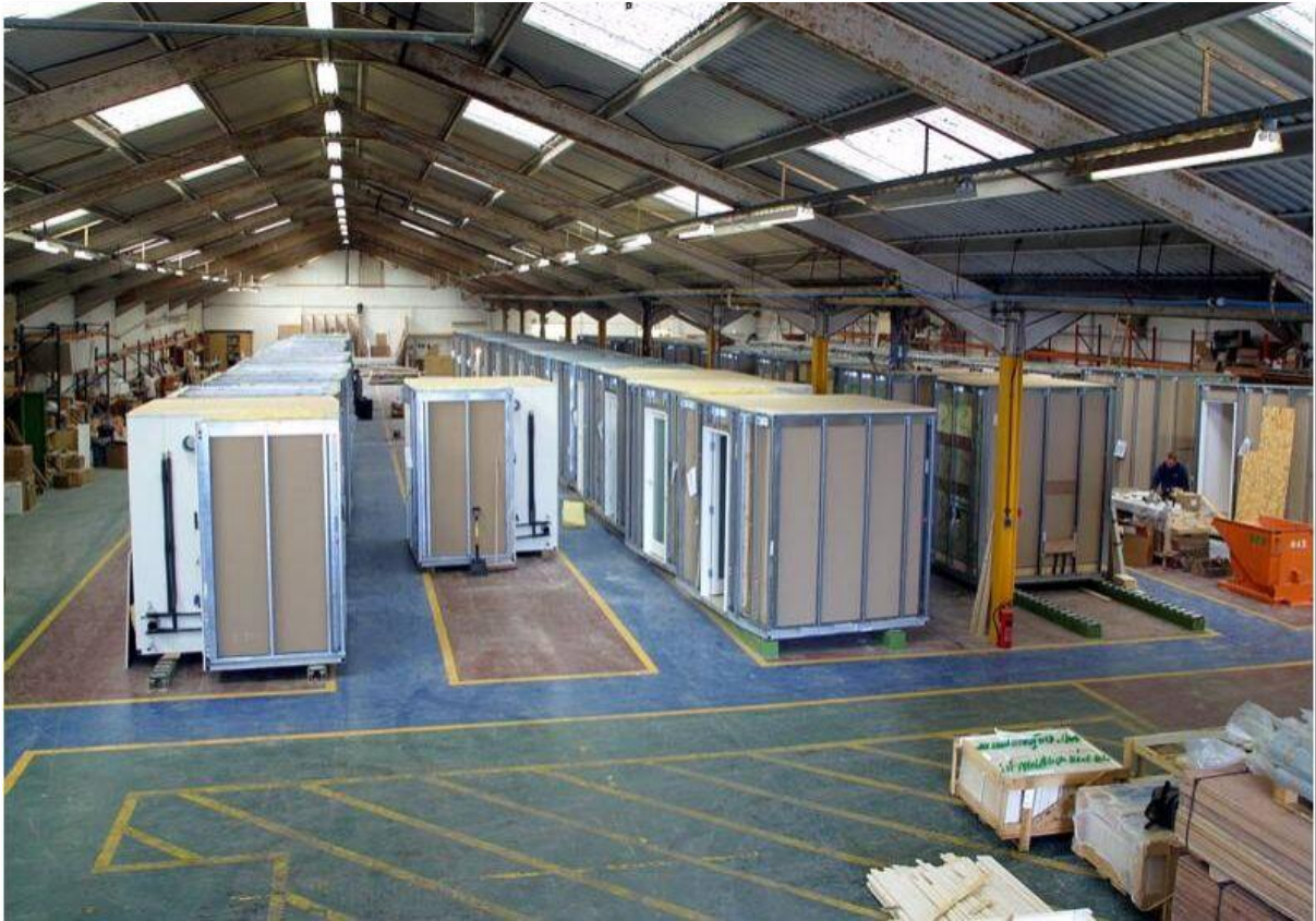
Figure 14: Vue intérieure d'un atelier industriel où sont fabriqués les modules (Intelligent Offsite (UK) – usine de modules modulaires)
