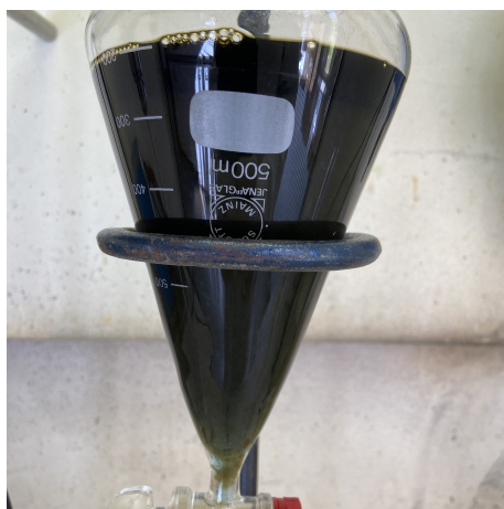
Figure 5.22 – Séparation des phases après cinq minutes de décantation
