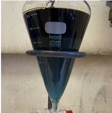
Figure 5.25 – Phases séparées après un essai d'extraction par solvant avec l'Acorga comme extractant
