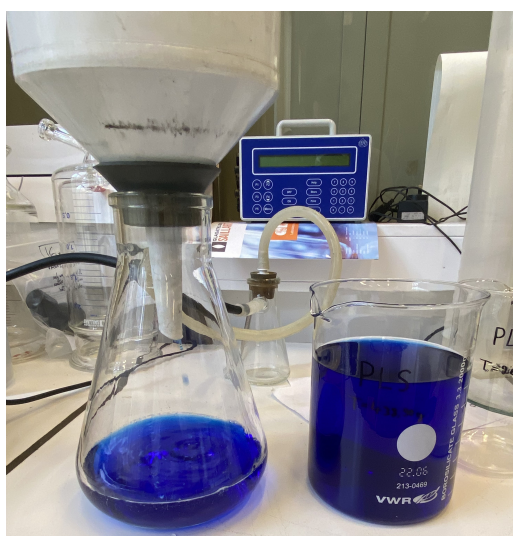
Figure 4.5 – Équipement utilisé pour la filtration : Entonnoir contenant le filtre papier, Erlenmeyer de récolte, tube relié à un récipient tampon (arrière-plan), et pompe (hors image)
