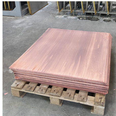
Figure 2.3 – Aperçus des cellules d'électrolyse (gauche) et des plaques de cuivres (droite) à la fin du procédé Biolix (COMET Traitements)
