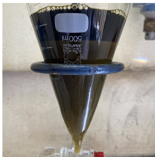
Figure 5.33 – Séparation des phases lors de l'extraction par solvant à partir d'une solution synthétique d'aluminium et de glycinate de cuivre
