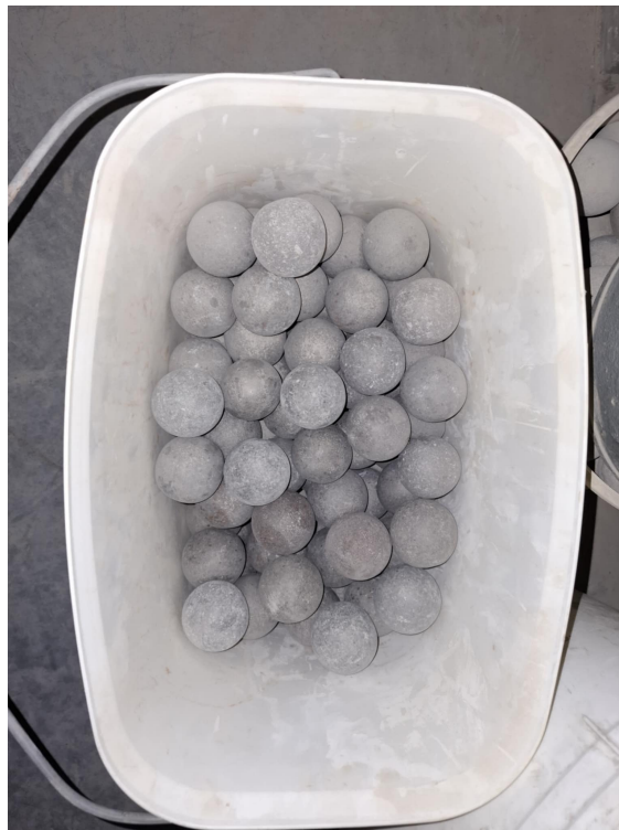
FIGURE 32 – boules d'acier (ArGEnCo - Laboratoire de Géotechnologies)
