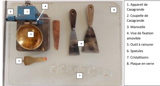
FIGURE 24 – : matériel utilisé pour l'essai de la limite d'Atterberg(ArGenCo-Laboratoire de Géotechnique)
