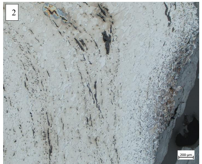
2 : Grains de ferrite déformés et écrouis au niveau du bord droit, vers un acier eutectoïde.
