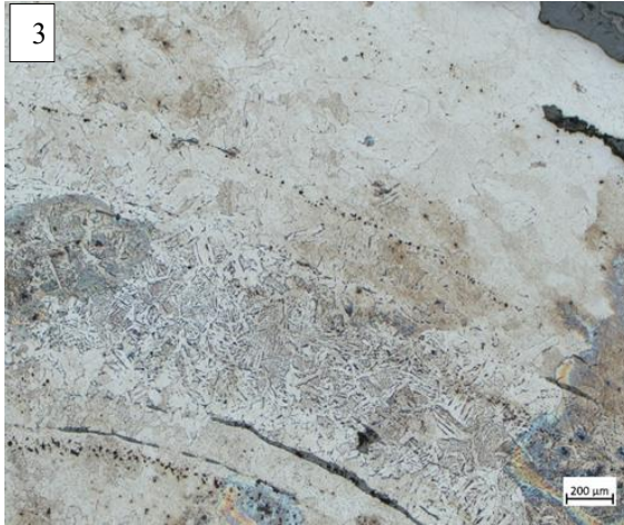
3 : Ferrite et bande d'acier à 0,4 % avec structures de Widmanstätten.
