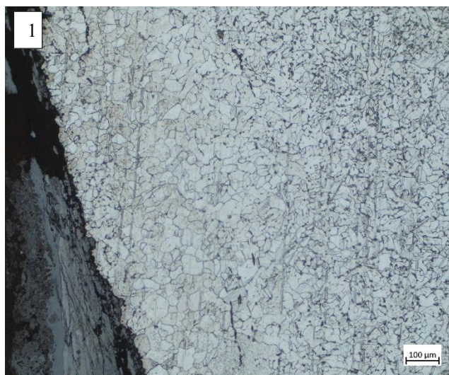
1 : Ferrite à petits et gros grains (gauche), acier à 0,1% de C environ.
