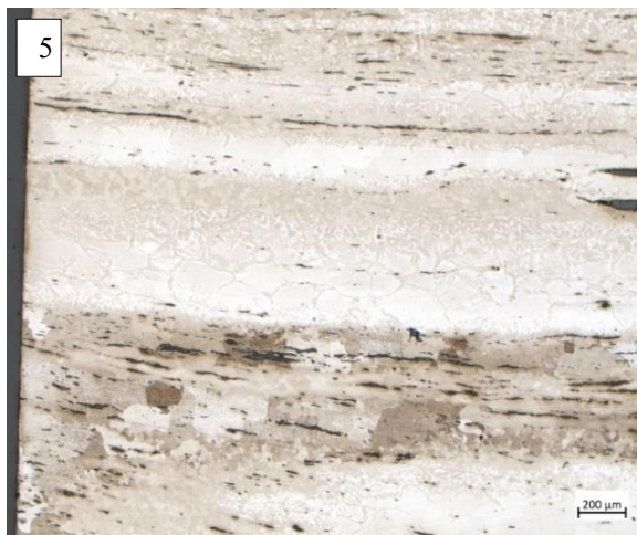
5 : Structures fantômes observées après attaque au réactif Oberhoffer.
