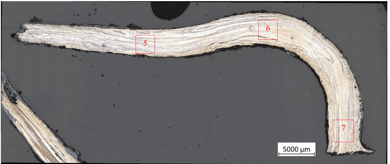
Mosaïque après attaque au réactif Oberhoffer
