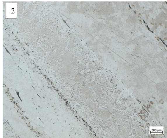
2 : Ferrite entourant une bande d'acier à 0,3-0,4% de C.
