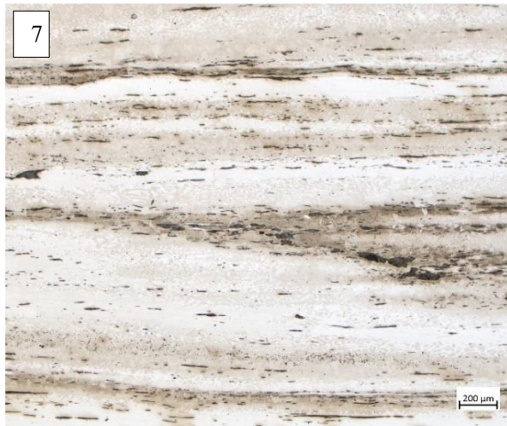
7 : Structures fantômes observées après attaque au réactif Oberhoffer.
