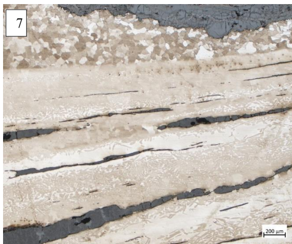
7 : Structures fantômes observées après attaque au réactif Oberhoffer.
