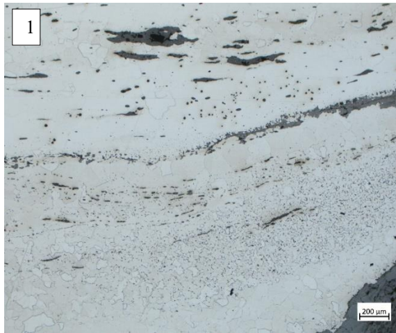
1 : Grains de ferrite de taille variable, acier à 0,1% de C et inclusions de scorie.
