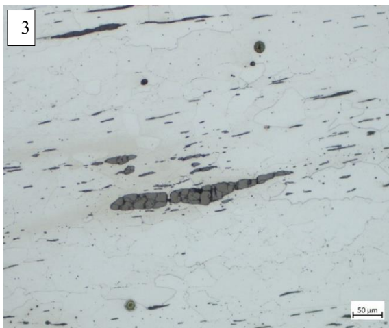
3 : Inclusion de scorie (aspect) dans matrice ferritique.
