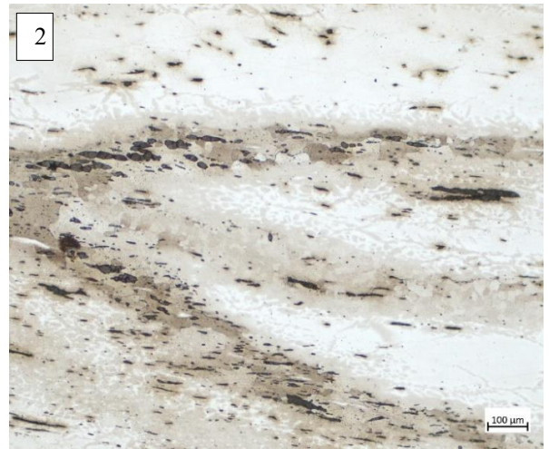
2 : Structures fantômes observées après attaque au réactif Oberhoffer.
