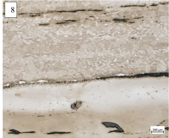
8 : Structures fantômes observées après attaque au réactif Oberhoffer (haut).
