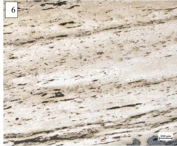
6 : Structures fantômes observées après attaque au réactif Oberhoffer.
