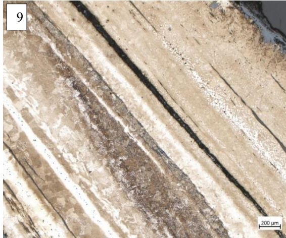
9 : Soudures révélées après attaque au réactif Oberhoffer.
