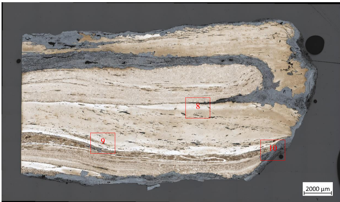
Mosaïque après attaque au réactif Oberhoffer
