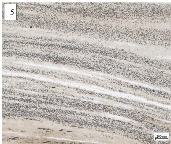
5 : Grains de ferrite de taille variables et soudures observées après attaque au réactif Oberhoffer.
