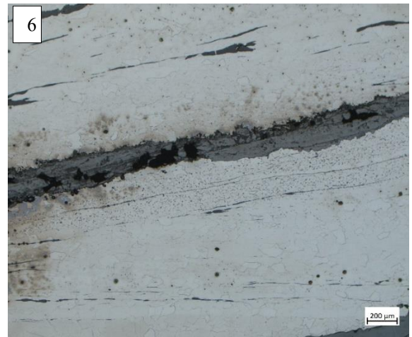
6 : Grains de ferrite localement plus carburés.
