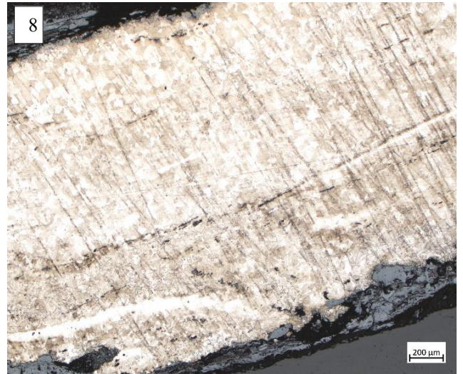
8 : Potentielles lignes de soudure
