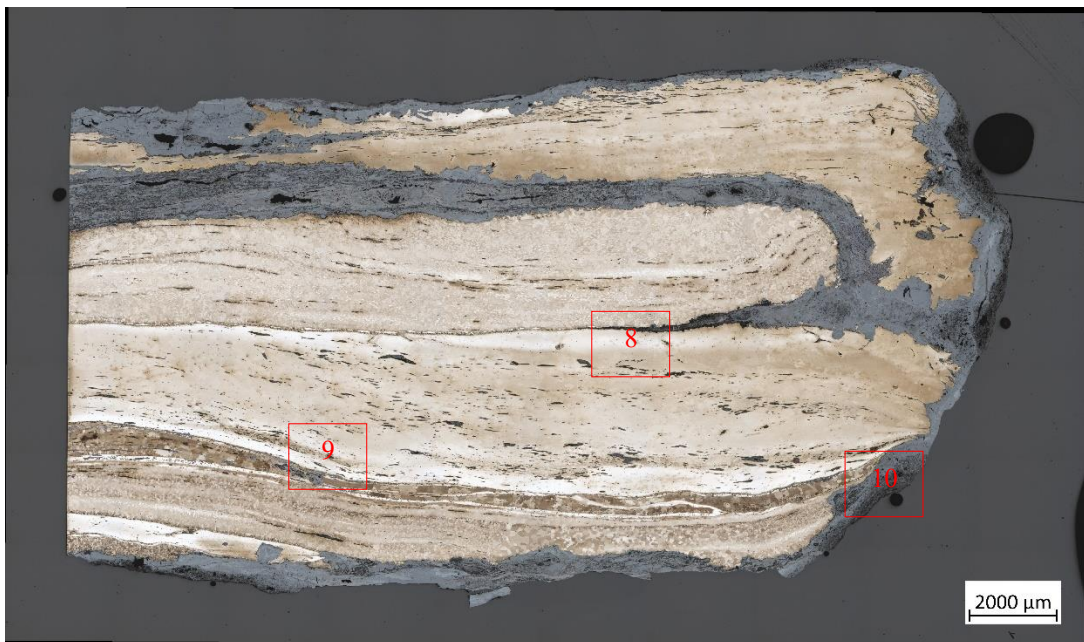
Mosaïque après attaque au réactif Oberhofer
