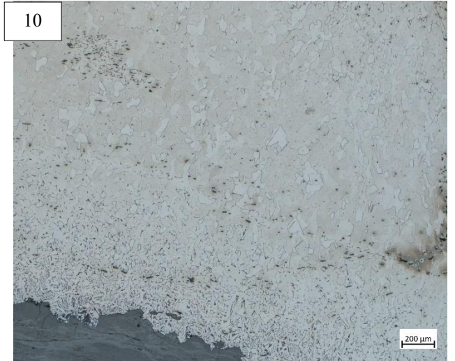
10. Gradation des teneurs en carbone du centre vers la périphérie de l'objet, ferrite (haut) et acier à environ 0,3%C.
