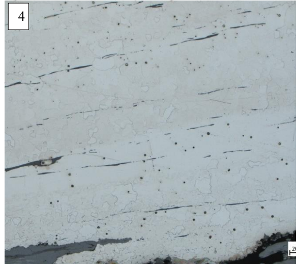
4 : Inclusions de scorie dans une matrice ferritique.
