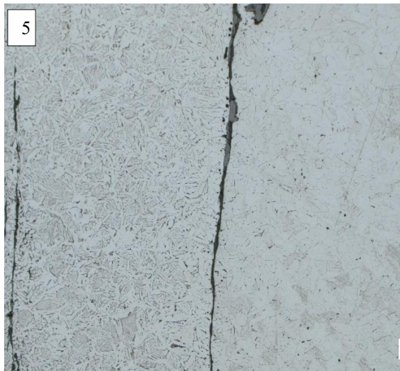
5 : Zone carburée (gauche) et zone ferritique (droite) de part et d'autre d'une soudure.
