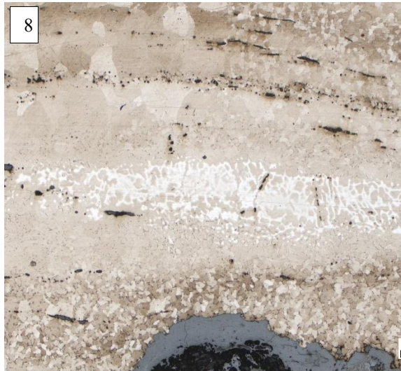
8 : Structures fantômes observées après attaque au réactif Oberhoffer.
