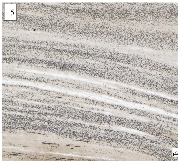
5 : Grains de ferrite de taille variables et soudures observées après attaque au réactif Oberhoffer.
