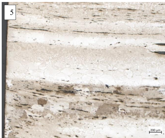
5 : Structures fantômes observées après attaque au réactif Oberhoffer.
