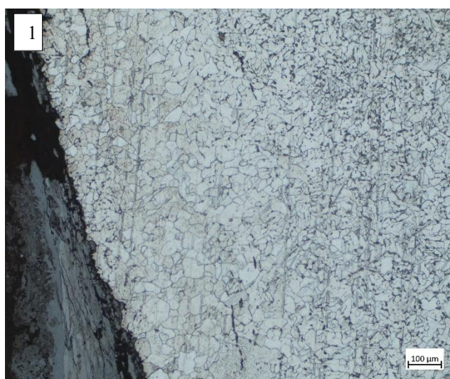
1 : Ferrite à petits et gros grains (gauche), acier à 0,1% de C environ.
