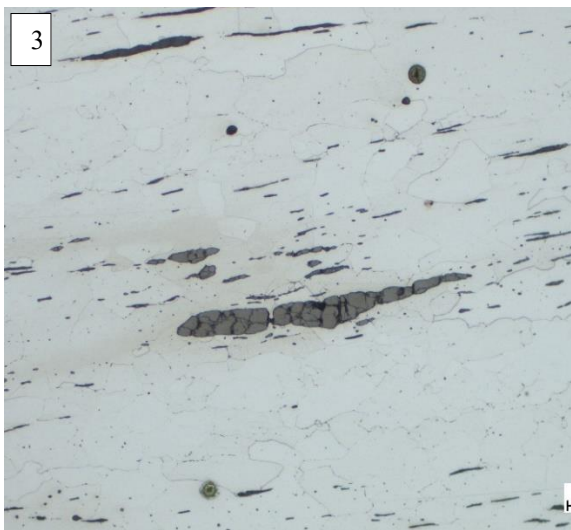
3 : Inclusion de scorie (aspect) dans matrice ferritique.
