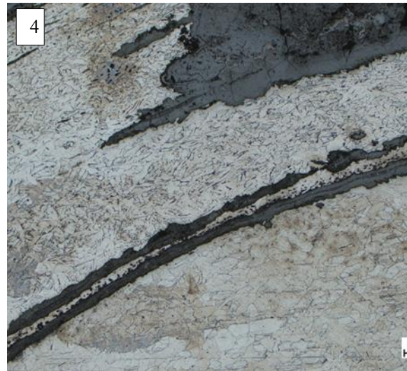
4 : Grains de ferrite et d'acier écrouis.
