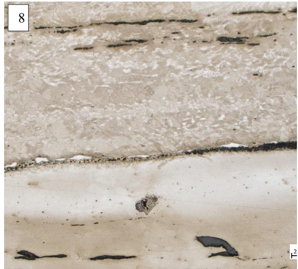
8 : Structures fantômes observées après attaque au réactif Oberhoffer (haut).
