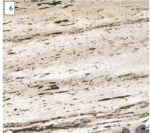
6 : Structures fantômes observées après attaque au réactif Oberhoffer.
