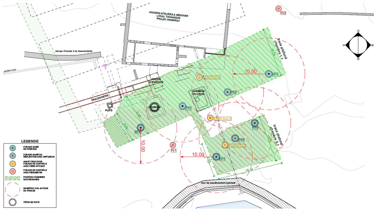
Figure 3-1 : Localisation des puits et des piézomètres par rapport aux cavités 0 et 1 des anciennes ardoisières de Martelange qui vont être exploitées pour du stockage thermique (Wingest Srl, 2024)
