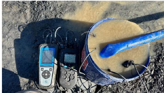
Figure 3-5 : Eaux pompées dans Pz1
