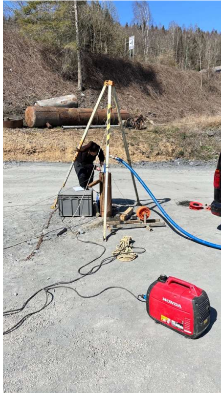
Figure 3-3 : Pompage dans Pz2 des anciennes ardoisières de Martelange
