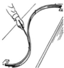
Figure 10: « Spline » ou cerce (Wikipédia).
