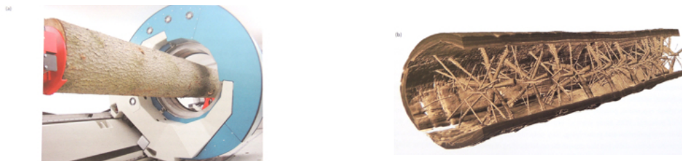
Figure 4: Tomographie d'un tronc d'arbre (Menges, 2017).
