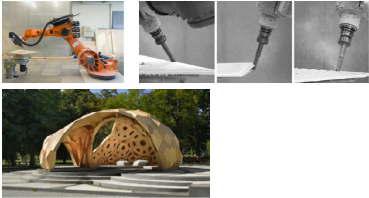
Figure 21: Préparation d'un assemblage à l'aide d'un fraiseuse actionnée par une bras à 7 axes pour la réalisation d'un pavillon (La Magna & al., 2013) dans RobArch 2013.
