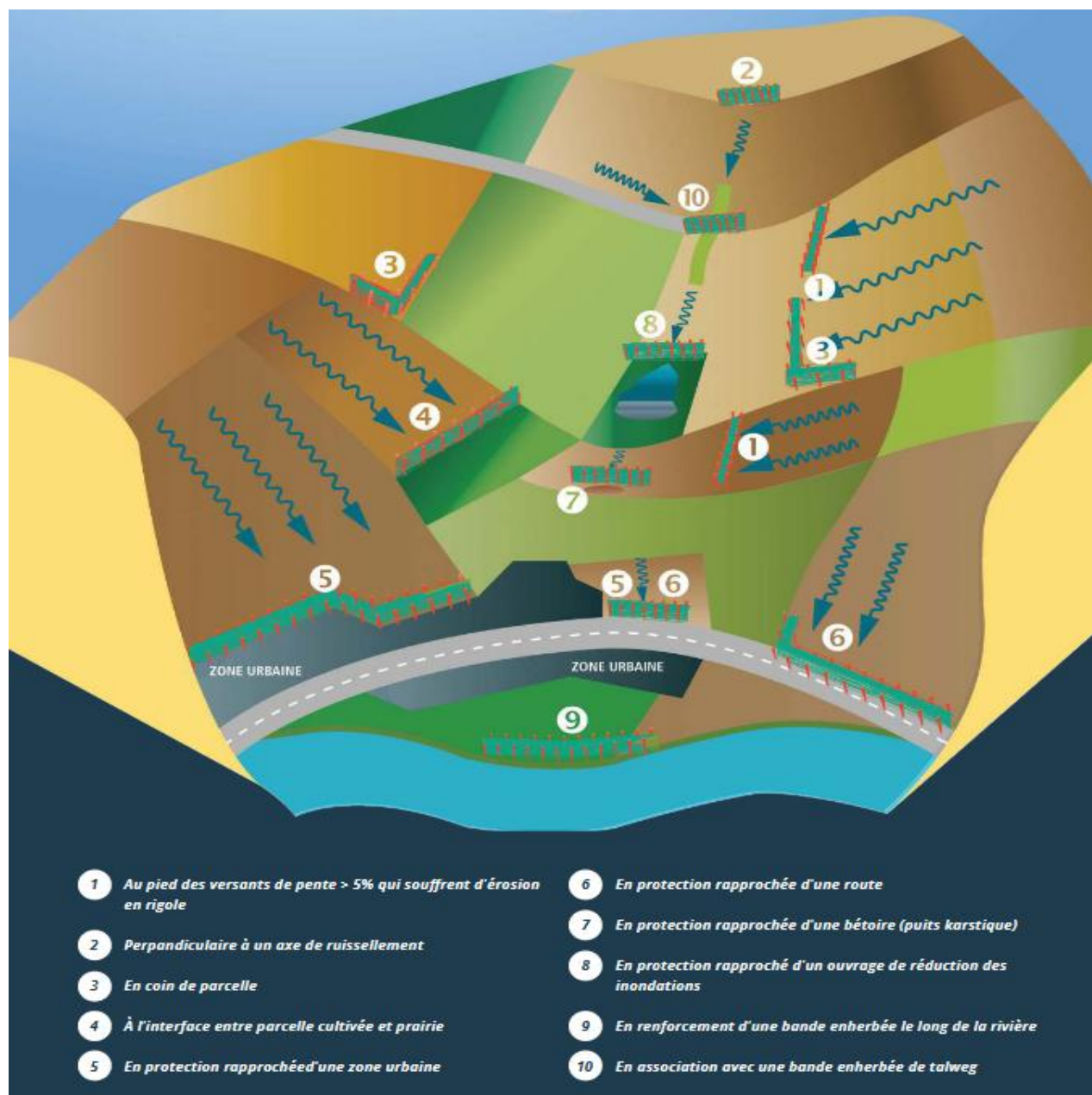
Figure 17 : Localisation stratégique des haies et fascines pour limiter le transfert des eaux de ruissellement (Ouvry et al., 2012; Richet et al., 2019)
