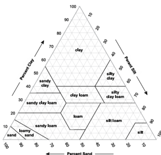
Figure 23 : Triangle textural du sol représentant les pourcentages d'argile, de limon et de sable pour les 12 classes texturales de base (USDA, 2017).
