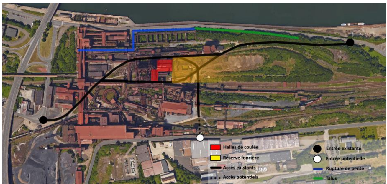
Figure 8.4 – Configuration des halles de coulée au sein du site (Vanoorbeek d'après Google Maps)
