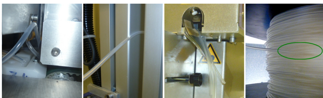
FIGURE 4.2 – Problèmes dus à l'adhérence du tube
