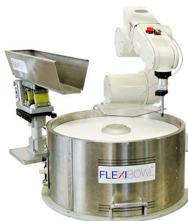
FIGURE 5.5 – Illustration du choix pour la gestion des connecteurs (ici système Flexibowl)
