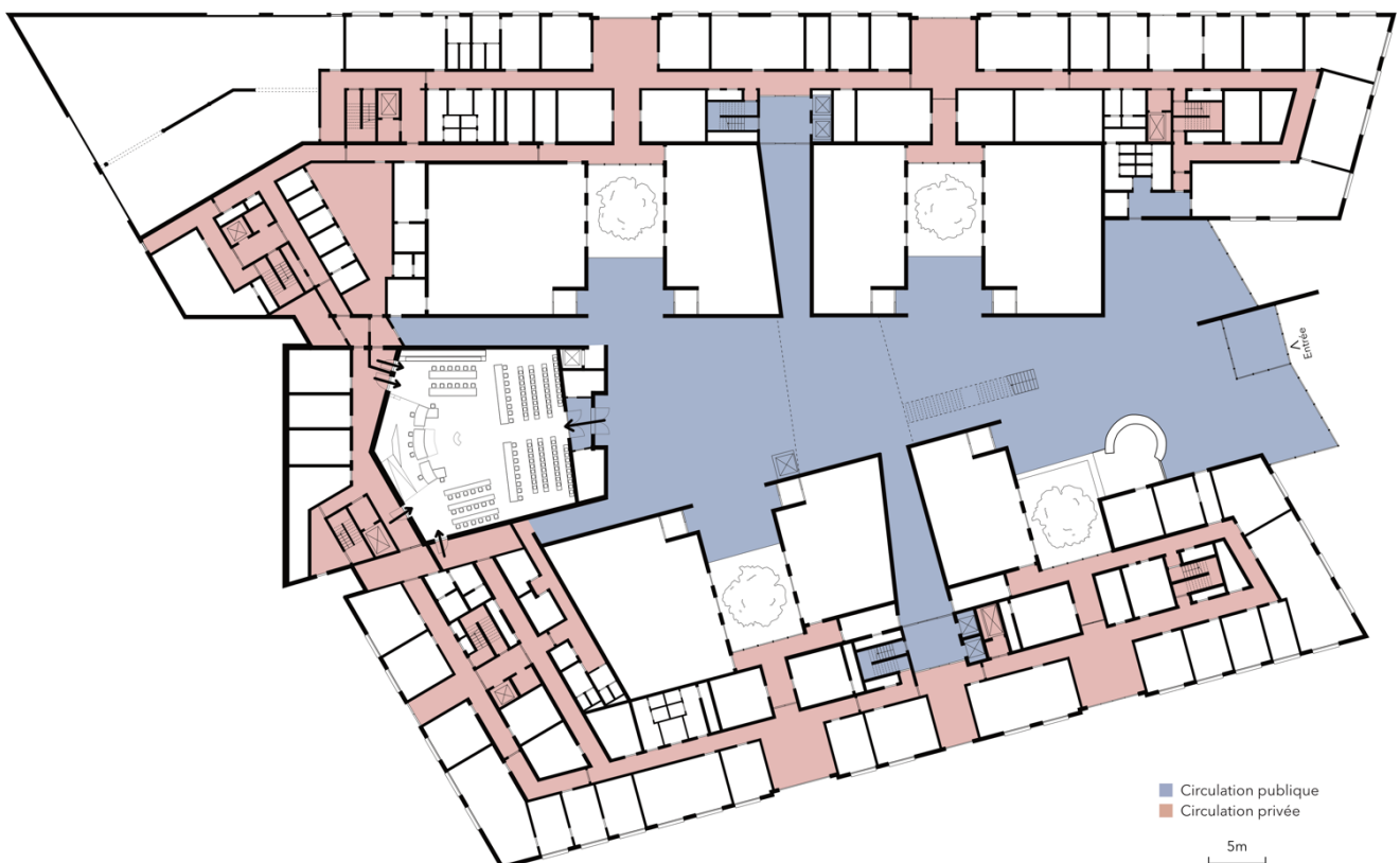
Fig. 27 : Espaces de circulation dans le Palais de Justice de Namur
