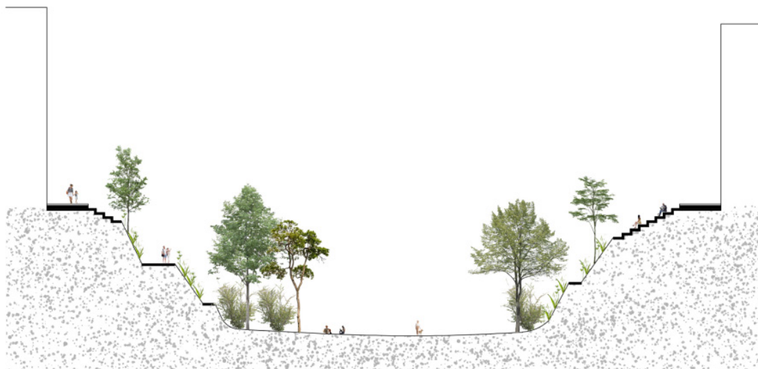
Figure 97 : Lit de la Rambla del Poyo aménagé selon le concept de rives poreuses en période sèche
