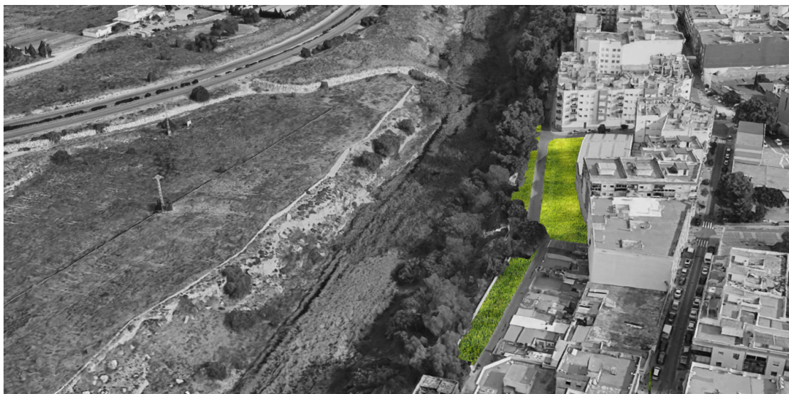
Figure 71 : Quai aménagé pour favoriser la transparence hydraulique dans un quartier en amont de Paiporta
