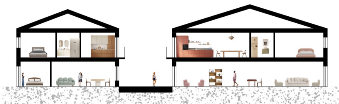
Figure 96 : Logements aménagés avec des rez- de-chaussée libres en période sèche
