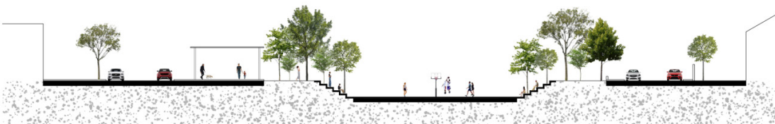
Figure 99 : Aire de jeu de la rue Catarroja aménagée comme un bassin multifonctionnel en période sèche
