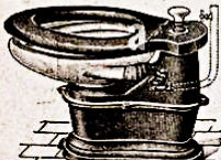
17-5104. Closet à siège dit "de baignoir" pour installation avec eau à faible pression provenant d'un réservoir, socle en fonte peinte avec trou pour tuyau de descente directe de 110 mm, cuvette porcelaine blanche ovale avec tubulure d'arrivée d'eau, siège verni à charnières, soupape de vidage en cuivre avec tirette à bouton porcelaine commandant à la fois l'ouverture de la soupape et l'arrivée d'eau. Raccord cuivre coudé pour tuyau plomb d'arrivée d'eau de 15x35 mm. Dim. d'encombrement 55x40 cm, h. du siège 42 cm. Pds total 18 kgs 500. Pour la pose, souder au raccord spécial le tuyau d'eau venant du réservoir. Il est bon de prévoir un robinet d'arrêt sur le parcours de ce tuyau. 275. »
