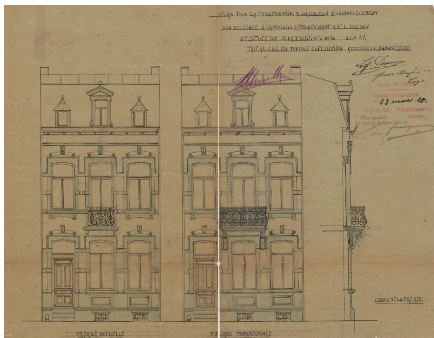
Figure 40: Élévation des travaux effectués en 1920 pour la transformation du balconnet en un balcon Source : Archives de la Ville de Liège
