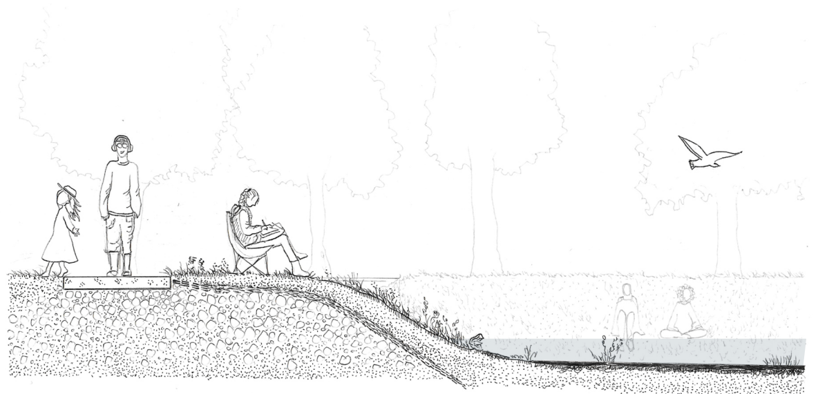
Figure 58: Coupe EE' - Les chemins principaux en eurodalle préfabriquées et réutilisables
