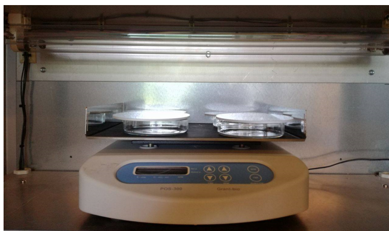
FIGURE 5.12: Essais photocatalytiques sur le bleu de méthylène dans un caisson.
