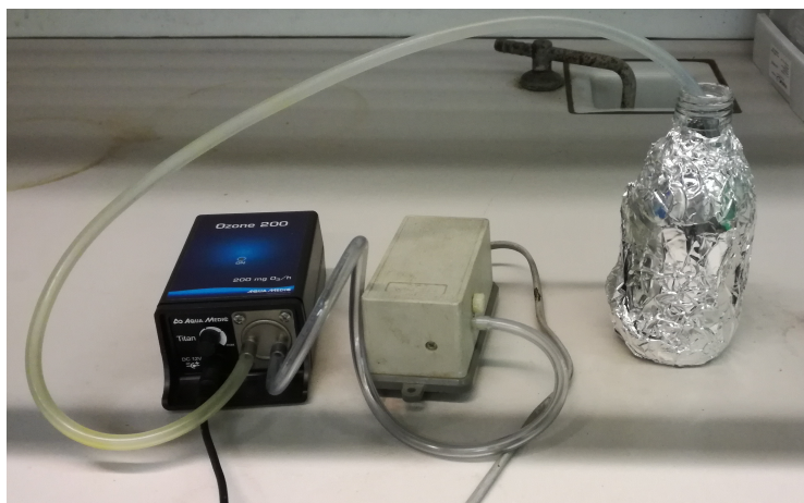
FIGURE 5.1: Ozonation des produits pharmaceutiques.
