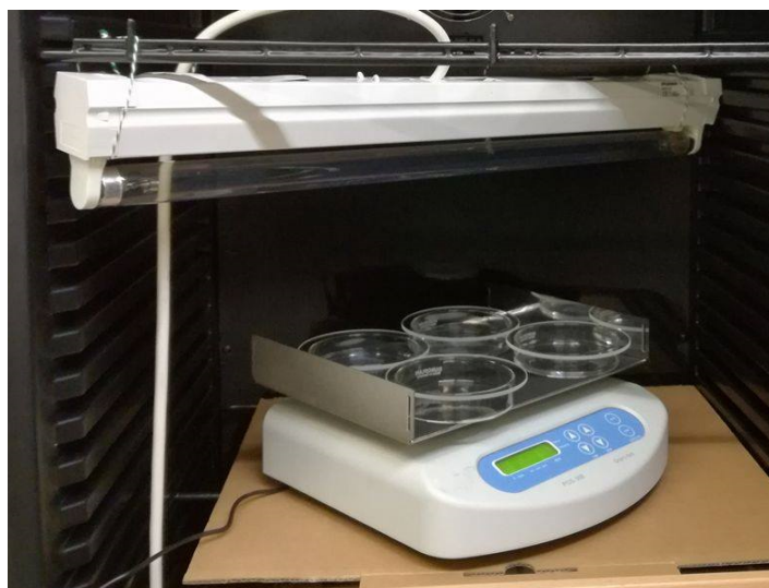
FIGURE 5.2: Essais photocatalytiques de dégradation des composés pharmaceutiques dans une cave à vin.
