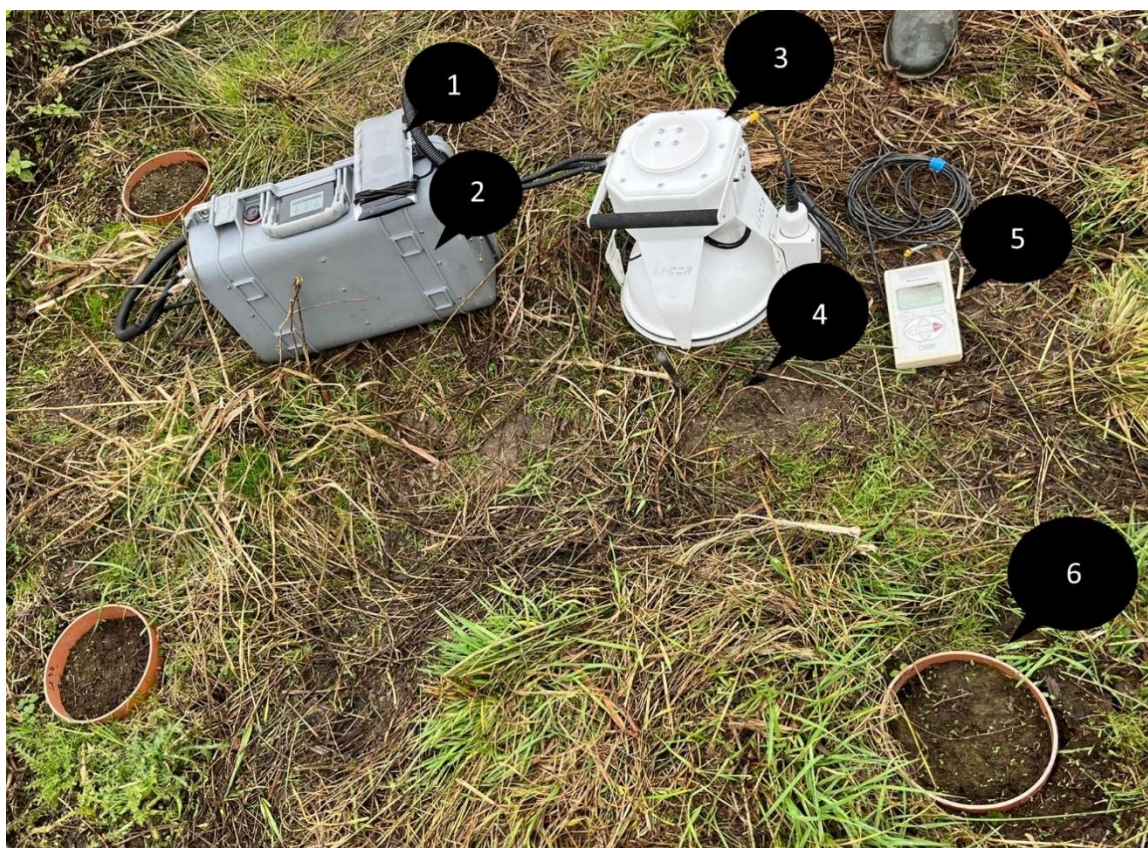
Figure 9 : Matériel de mesure : Téléphone servant au contrôle de la chambre (1), Analyseur portable (2), Chambre (Smart Chamber) (3), Sonde 5TM (4), Lecteur portable ProCheck (5) et Anneau en PVC (6) source : photo personnelle
