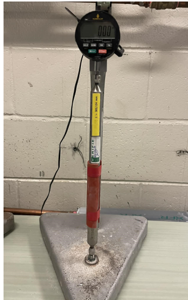
FIGURE 26 – Comparateur de longueur avec tige de référence
