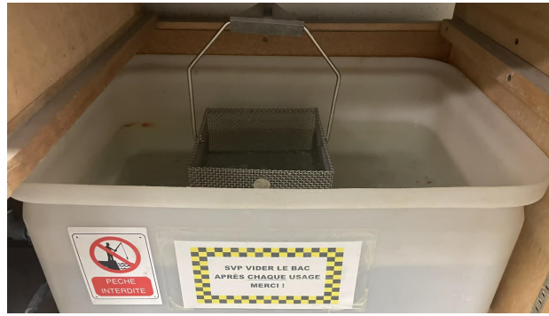
FIGURE 36 – Mesure de la masse déjaugée à l'aide d'un dispositif relié à la balance.
