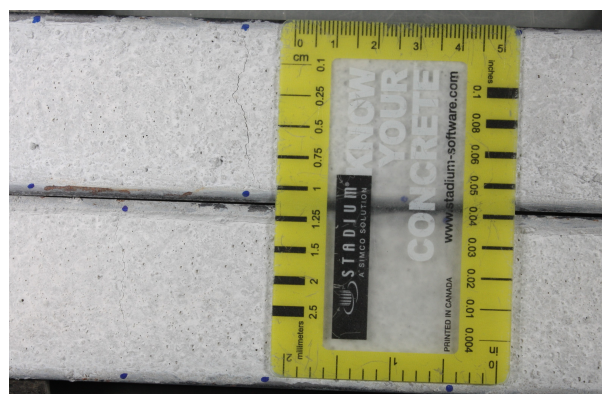
FIGURE 175 – Fissuration observée à l'oeil nu pour le mélange RS1 (après 60j)
