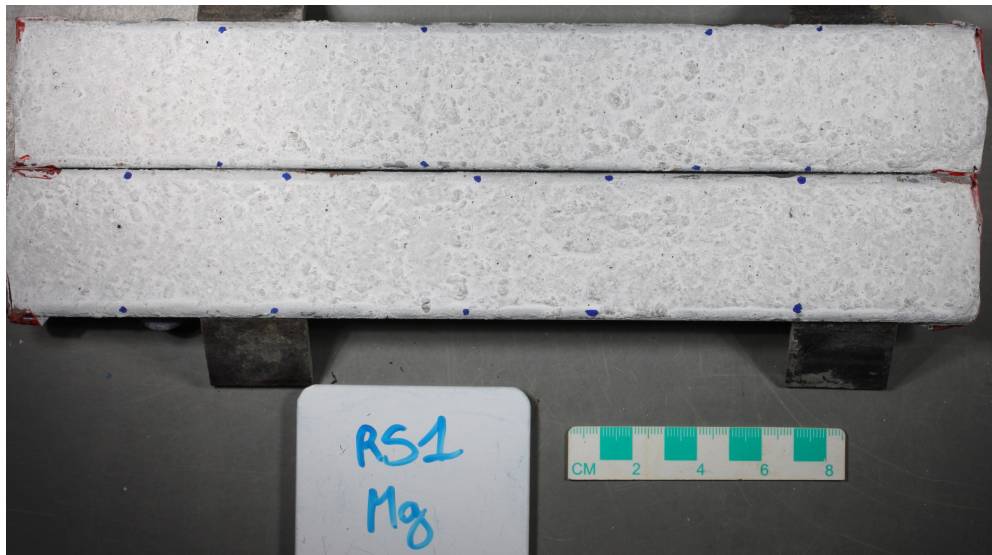
FIGURE 176 – Evolution de la fissuration du mélange RS1+ MgO (après 60j)
