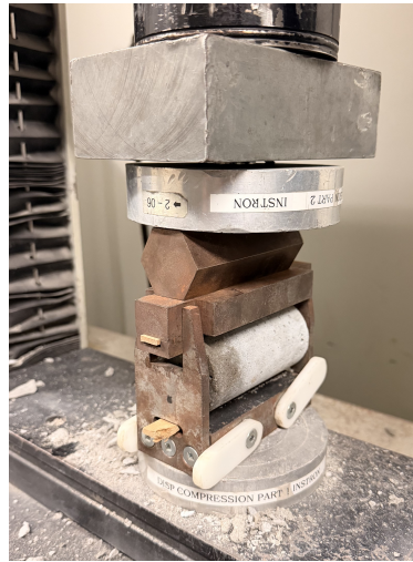
FIGURE 33 – Essai de résistance à la traction : dispositif sur la presse (INSTRON)
