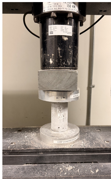
FIGURE 34 – Dispositif module de Young (INSTRON)
