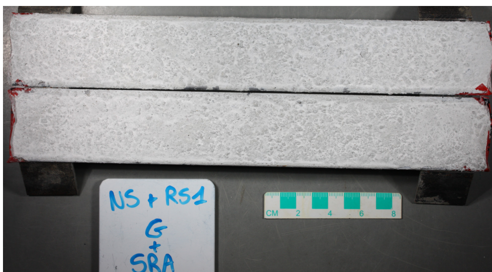
FIGURE 193 – Evolution de la fissuration du mélange NS-RS1 G+SRA (après 60j)
