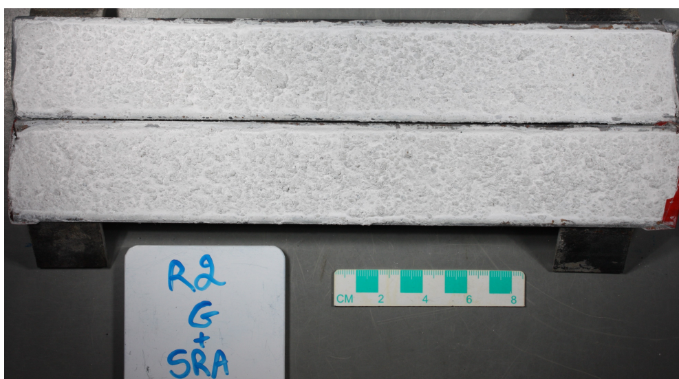
FIGURE 187 – Evolution de la fissuration du mélange RS2 G+SRA (après 60j)
