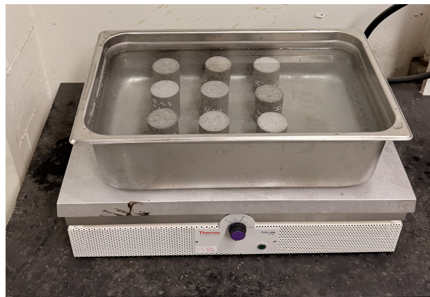
FIGURE 35 – Mise en ébullition des échantillons.
