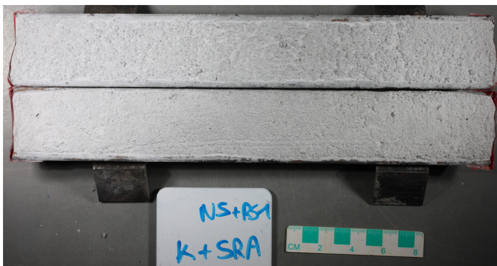
FIGURE 194 – Evolution de la fissuration du mélange NS-RS1 K+SRA (après 60j)
