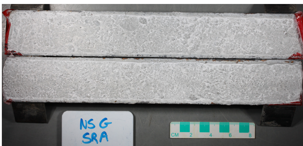
FIGURE 172 – Evolution de la fissuration du mélange NS G+SRA (après 60j)
