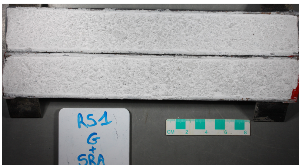
FIGURE 181 – Evolution de la fissuration du mélange RS1 G+SRA (après 60j)
