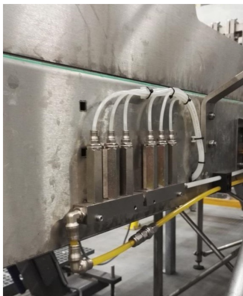
FIGURE 5.7 – Système de lubrification sèche installé sur la Quikflex (vue du côté du convoyeur d'entrée).
