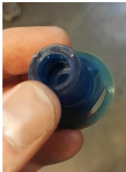
FIGURE 6.13 – Ventouse utilisée du magasin de cartons de la Wraparoundpacker .
