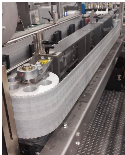
FIGURE 4.9 – Système de compression des packs de la Quikflex .
