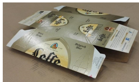
FIGURE 3.4 – Découpe en carton d'un pack de 12 bouteilles de Leffe au format 25cl.
