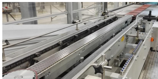
FIGURE 4.12 – Système de rotation des packs de la Quikflex .
