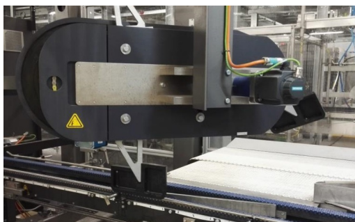
FIGURE 4.10 – Système d'éjection de la Quikflex .
