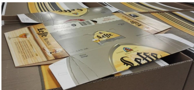
FIGURE 3.3 – Découpe en carton d'un pack de 20 bouteilles de Leffe au format 25cl pour la Quikflex .
