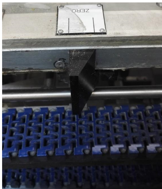
FIGURE 5.9 – Exemple de réglage d’un point zéro (référence) du servomoteur du séparateur de la Quikflex .
