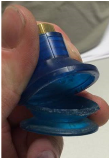
FIGURE 6.8 – Ventouse de prise du carton déchirée sur la Quikflex .
