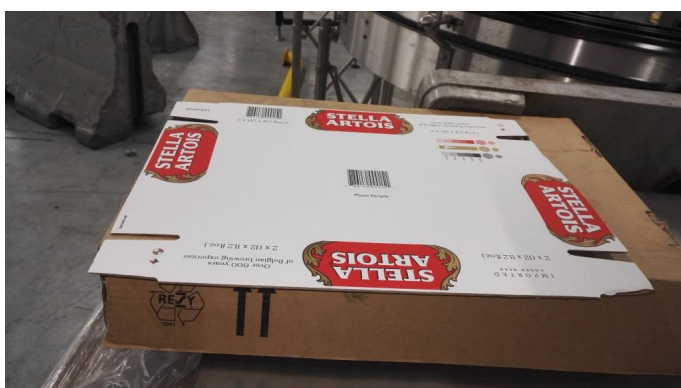
FIGURE 3.7 – Découpe en carton d'une barquette pour 2 packs de 12 bouteilles de Stella Artois 33cl pour la Traypacker .
