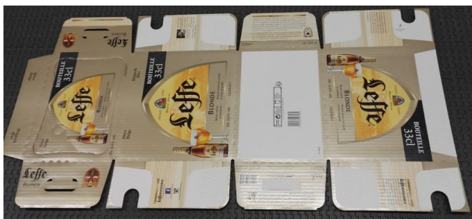
FIGURE 3.5 – Découpe en carton d'un pack de 12 bouteilles de Leffe au format 33cl utilisé dans la Wraparoundpacker .
