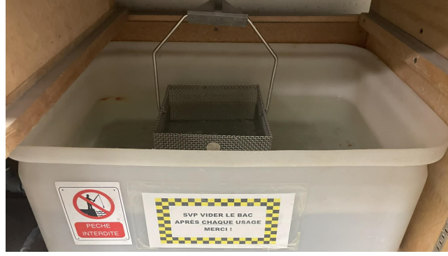
FIGURE 40 – Mesure de la masse déjaugée à l’aide d’un dispositif relié à la balance
