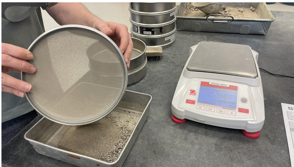
FIGURE 21 – Pesée des fractions retenues après tamisage à sec
