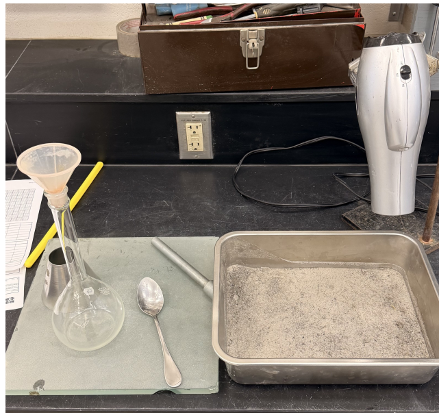
FIGURE 26 – Matériel nécessaire pour atteindre (à droite) et vérifier (à gauche) l'état SSS
