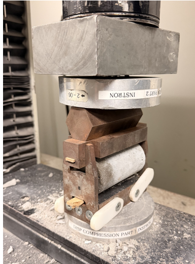
FIGURE 37 – Essai de résistance à la traction : dispositif sur la presse (INSTRON)
