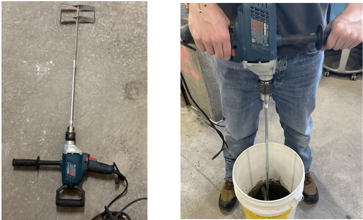
FIGURE 27 – Malaxeur manuel utilisé pour la préparation des mélanges
