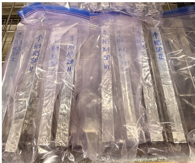
FIGURE 34 – Conditionnement des éprouvettes scellées dans la chambre humide
