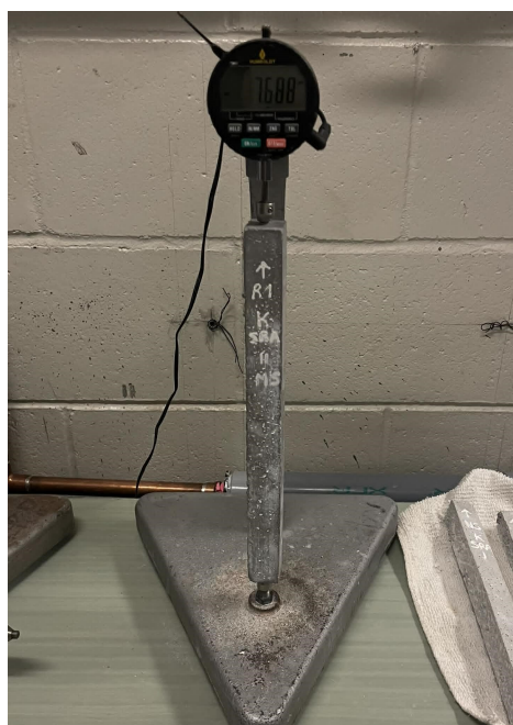
(a) Mesure du retrait d'une éprouvette
