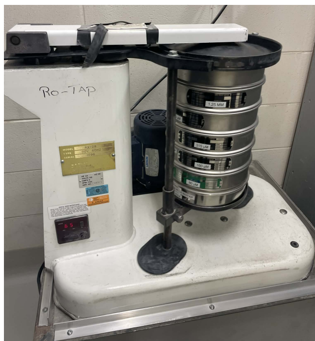
FIGURE 20 – Ro-Tap : Système de tamisage
