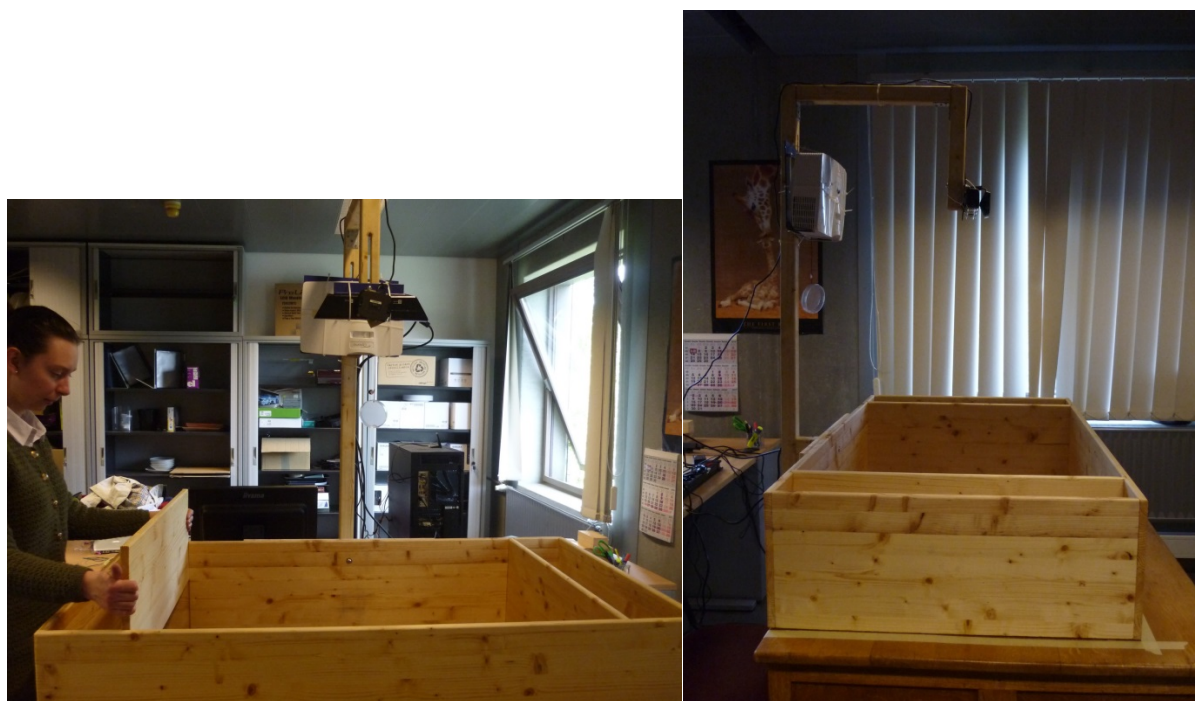
Figure 25 : Bac à sable à réalité augmentée : bac et potence
