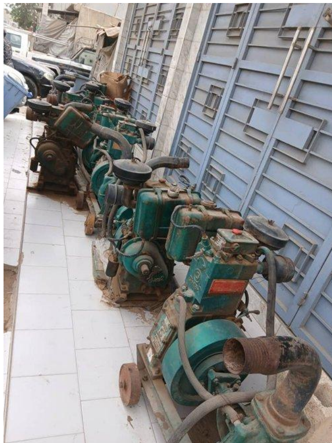
Photo 4 : Motopompes à moteur diesel mobilisées par des acteurs communautaires pour l'évacuation des eaux pluviales ( Cliché : DIALLO M.Y., terrain 2026 )
