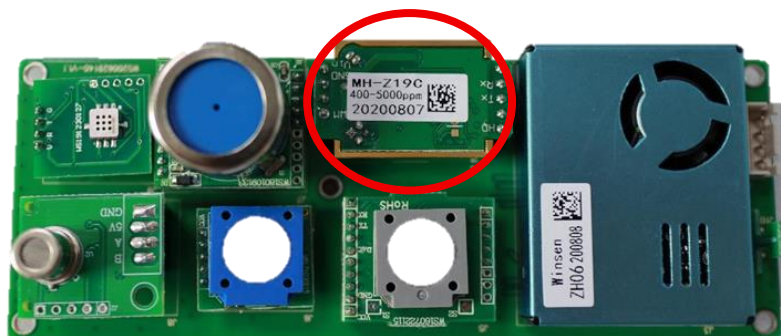
Figure 11 : Module Winsen et capteur CO 2
