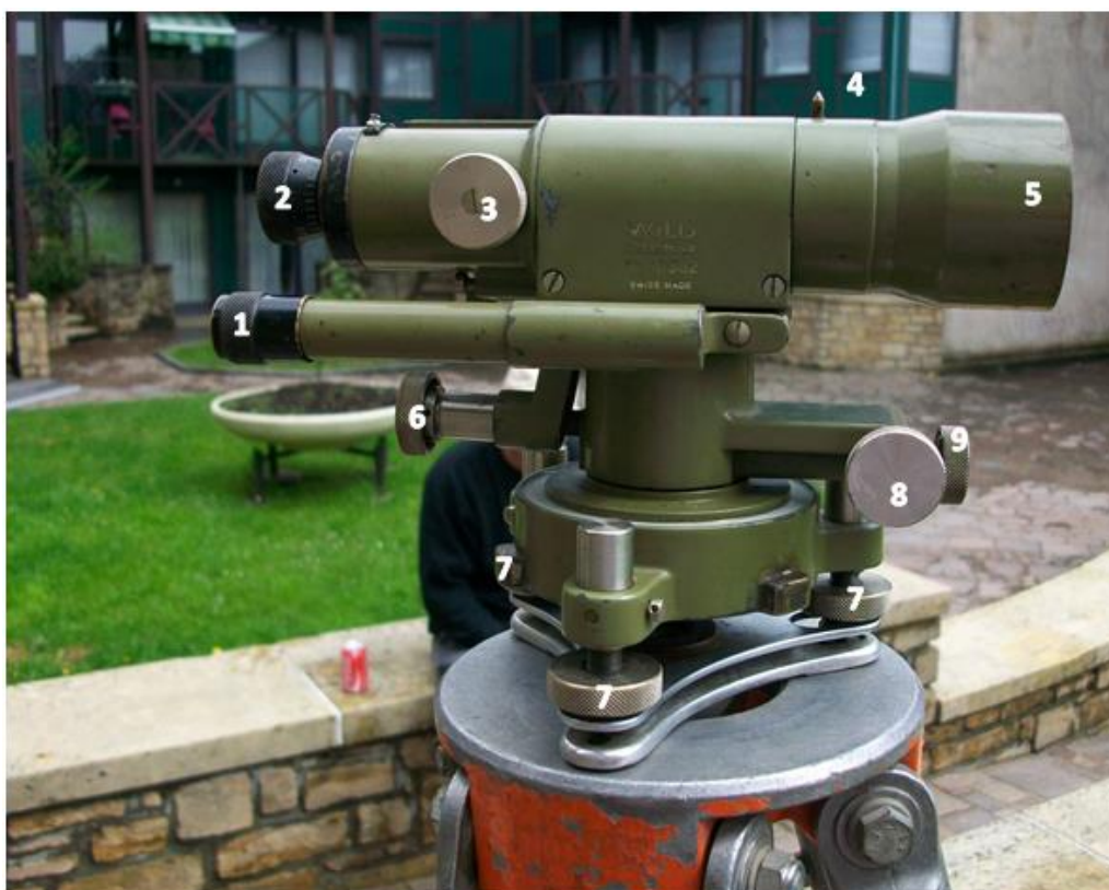
Figure 62: Partie droite du niveau (Guichets Energie (Région wallonne), 2013)
