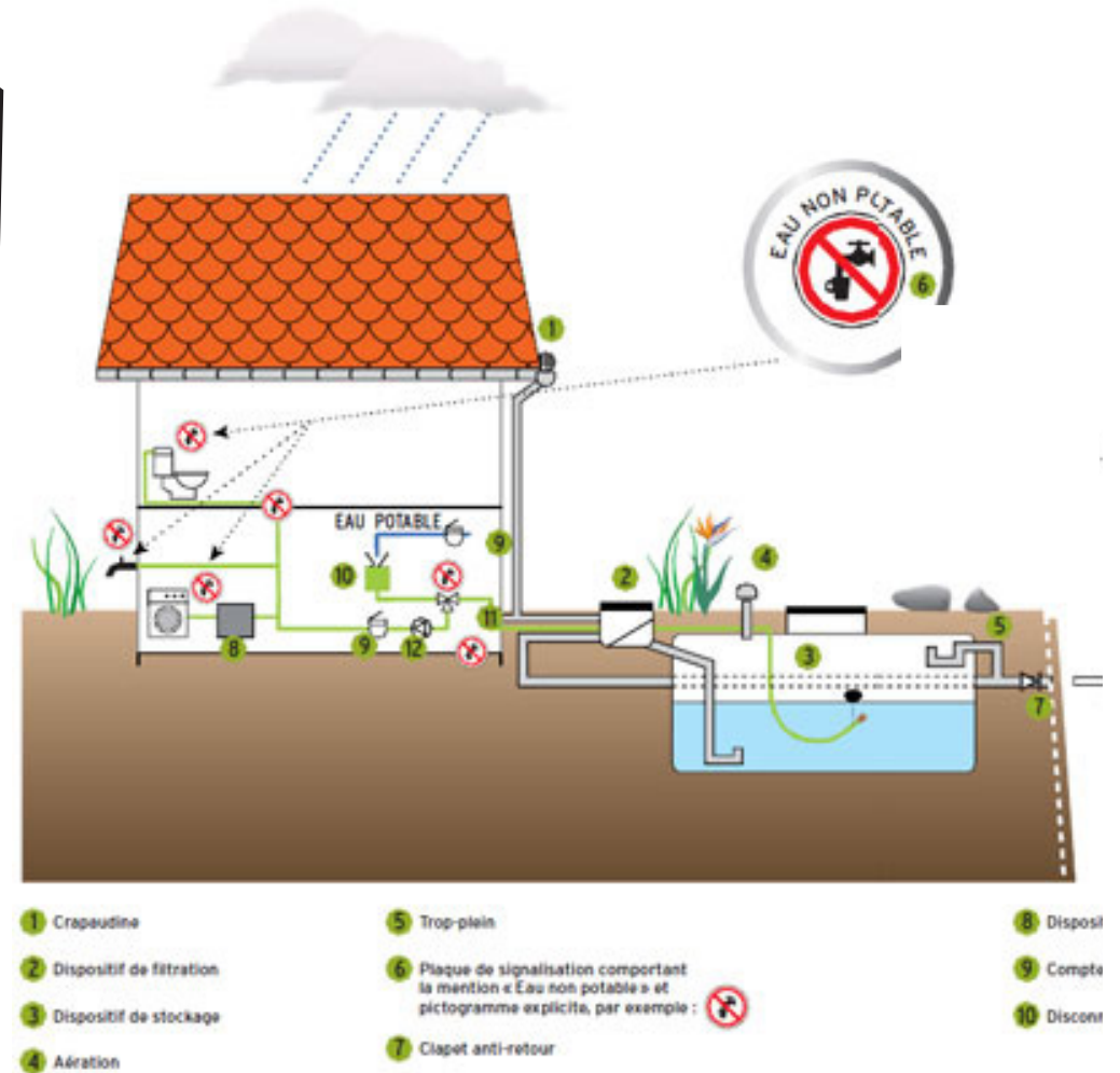
Figure 4.34 : Principe de la récupération de l'eau de toiture en citerne souterraine (Bertrand 2011)
