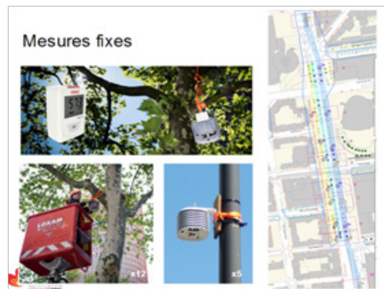
Figure 3.9 : Dispositifs de mesures de températures dans la rue Garibaldi (Ponsar 2016)
