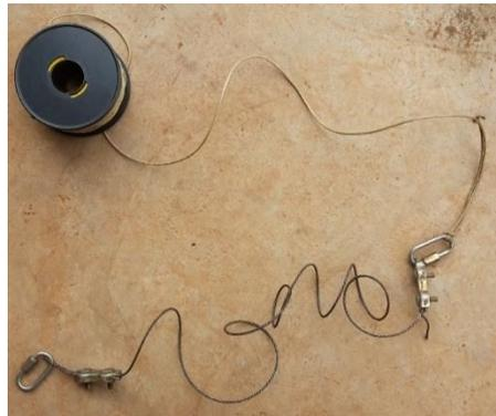
Figure 10 : Scie flexible attachée à une bobine de ficelle
