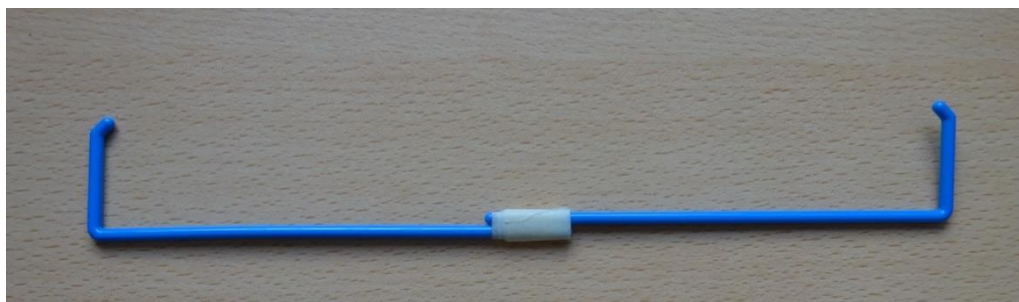
Figure 10 - Dispositif permettant l'étalement de la suspension de spores sur l'ensemble de la surface du milieu contenu dans les flasques réalisé à l'aide de deux râtaux mis bout à bout.
