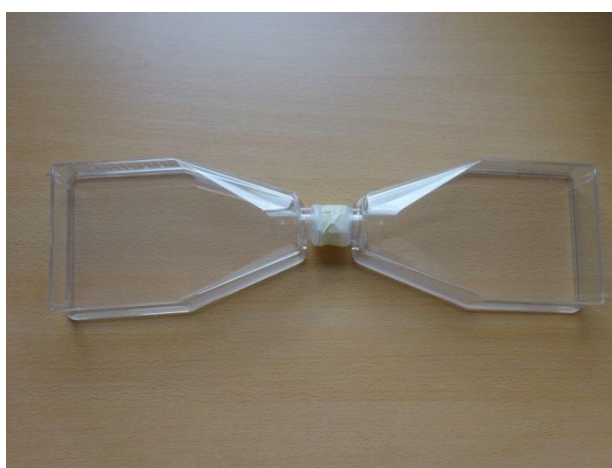
Figure 7 - Dispositif expérimental pour l'étude des effets des bouquets de COVs émis par F. culmorum ou C. sativus en situation de stress sur la croissance des champignons eux-mêmes.
