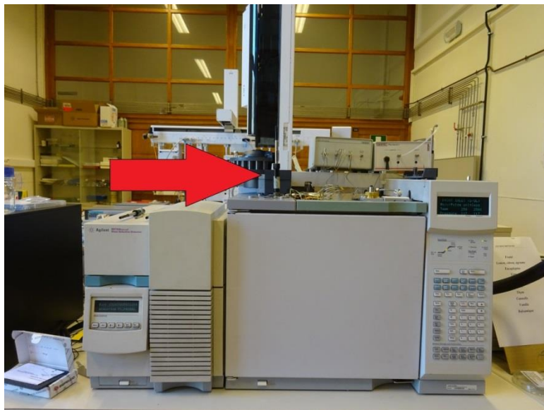
Figure 6 - Machine de chromatographie sur phase gazeuse couplée à une spectrométrie de masse. La flèche rouge désigne le lieu de l'insertion de la fibre SPME.
