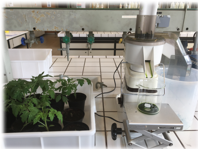
Figure 11. Centrifugeuse servant à récolter le jus des plants de tomates (photo : Van De Velde Megane)
