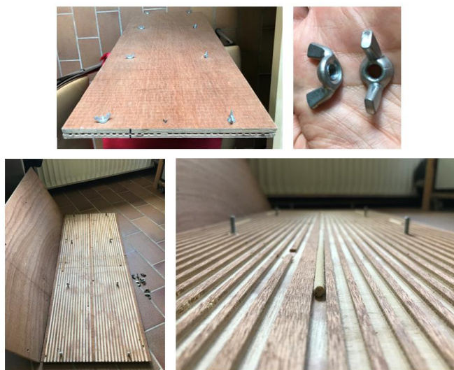
Figure 17 : Construction d'un séchoir pour la préparation des carottes (Photo : Taverniers, 2017)
